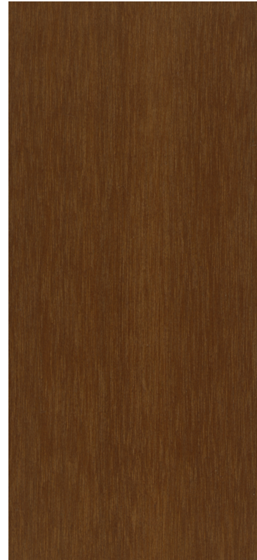
Débit sur faux quartier
